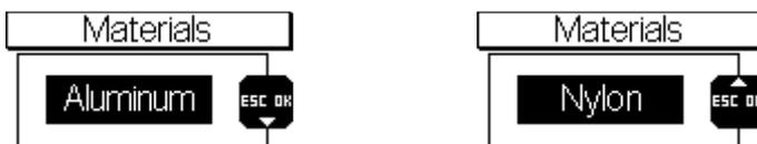
Die 9 Materialien sind: Aluminium, Titan, Stahl, Edelstahl, Glas, Kupfer, Messing, Styropor und Nylon.
