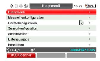
Wählen Sie im Hauptmenü mit den Tasten "↑" oder "↓" den gewünschten Menüpunkt, z.B. "Gerätekonfiguration", aus und bestätigen Sie mit der Taste "OK" ■. Der gewählte Menüpunkt wird aufgerufen.
