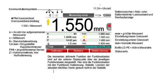
a) Die Werkskalibrierung wird für die einfache, schnelle Messung verwendet, wenn auch größere Messfehler zugelassen werden. Andere Kalibrierarten siehe Bedienungsanleitung.
