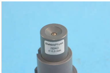
Zero-Kalibrierstandard mit einer eingelegten Messkugel
