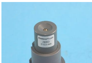
Zero-Kalibrierstandard mit einer eingelegten Messkugel
