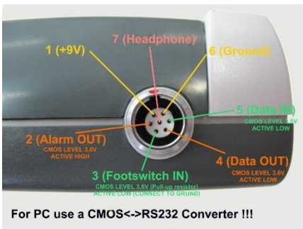
An den Alarmausgang kann ein optisches oder akustisches Warngerät angeschlossen werden.
