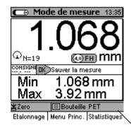
Diamètre de la bille d'acier Réglage actif: 4.0 mm
